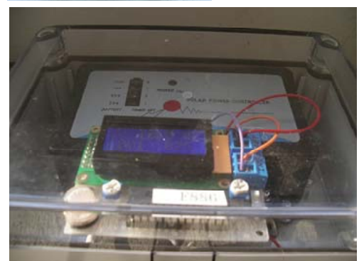
LCD 2行目左の現在の暗さ(0~100)数値が、右の設定値(0~100)を上回ると点灯する
